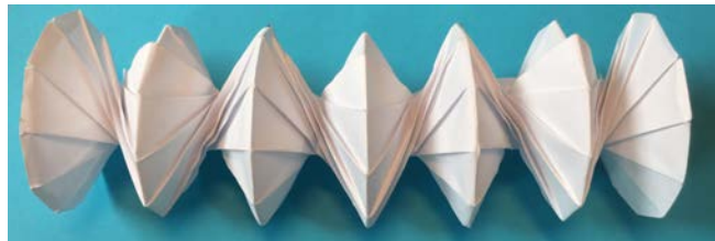
Abbildung 4: Konzept einer Faltstruktur mit möglicher Anwendung als neuartiges Crashelement
