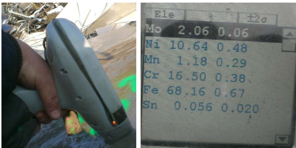
Abbildung 3: Messung mittels Röntgenfluoreszenz-Spektrometer
