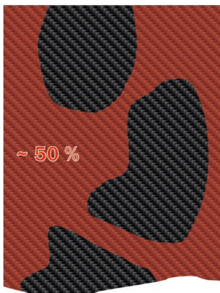
Subtraktiver Prozess aus Gewebepahnen: Verschnitt: ~ 50 %
