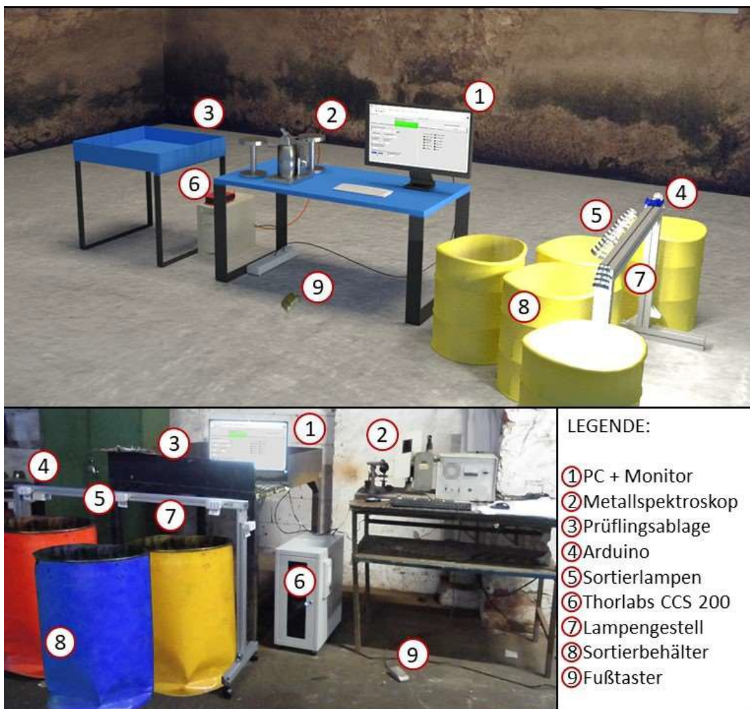
Abbildung 3: 3D-Modell (oben) und Aufbau des Demonstrator-Arbeitsplatz bei Cronimet (unten) [Fritz 2018]
