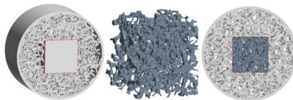
Abb. 9: Synthetische Schaumstruktur mit skalierten Membranstruktur als innovativer Adsorber (TinniT)
