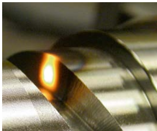
Abbildung 2: Laserhärten an einer scharfkantigen Geometrie
