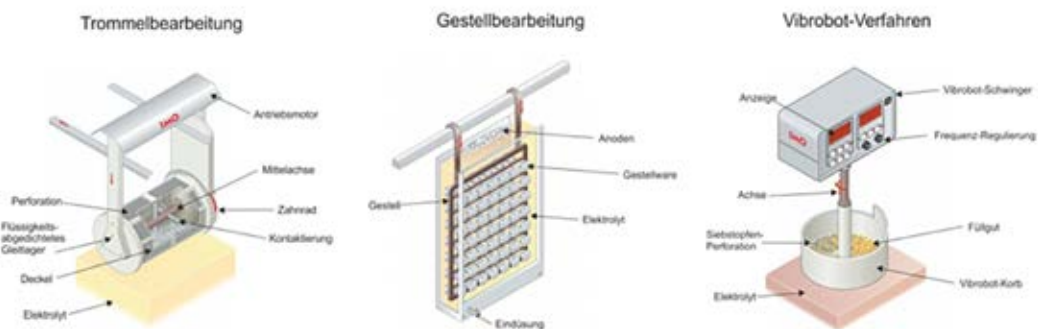
Bild 19: Verfahren der Einzelteilgalvanik [12]
