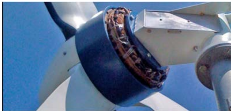
Abb. 4: Moderne, getriebelose Windturbinen benötigen ca. 600 kg/MW Magnete auf Basis Seltener Erden
