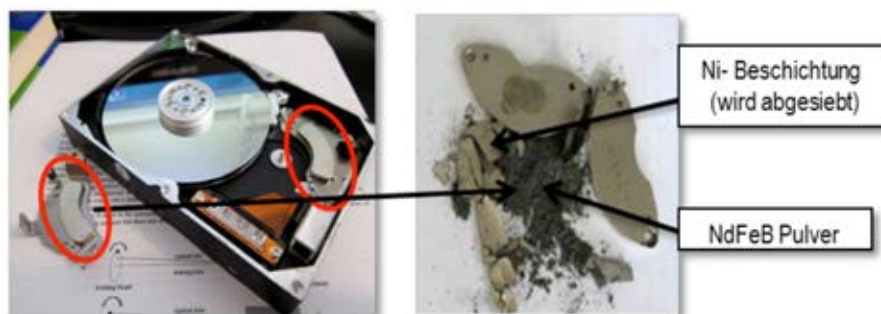
Abb. 8 links: Computerfestplatte mit Nd-Fe-B-Magnet (roter Kreis), rechts: Magnet nach Wasserstoffbehandlung
