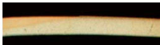
Schliff durch den Randbereich: kein Angriff auf die Al-Schicht
