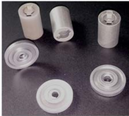
Abb. 10: Nd-Fe-B Magnete aus Recyclingmaterial, hergestellt im SDS Verfahren
