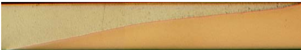
Schliff durch den Übergangsbereich
