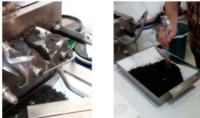
Abb. 9 links: zur Illustration geöffneter Knetmischer, rechts: Endprodukt
