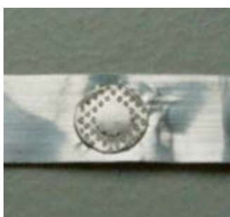
Mit Kupfer vollplattiertes Aluminium-Bändchen, Dicke 0,13 mm, mit aufplattierter Cu-Schicht und ca. 2µm galvanischer Silber Beschichtung
