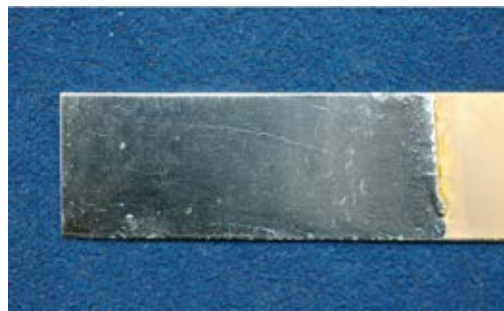
Abb. 3 Dip-and-Look-Löttest -> Ohne Entnetzungen
