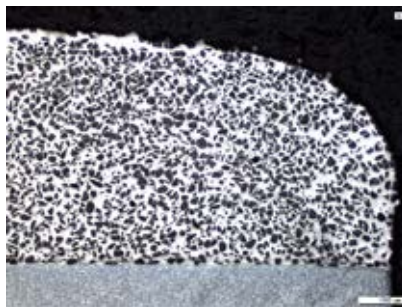
Abbildung 6: Applizierte Verschleißschutzschicht mit WC
