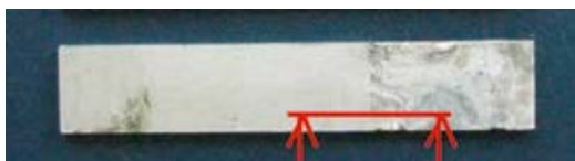
Prüfling mit verzinnter Kante nach Salznebelsprühtest
