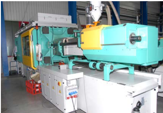
Bild 6: Vollautomatische Spritzgießmaschine mit einer Schließkraft von 5.500 kN und Schussgewichten bis 1,8 kg.
