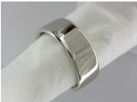
Bild 6: Ring aus Au-BMG1 a) direkt nach dem Gießen und Polieren
