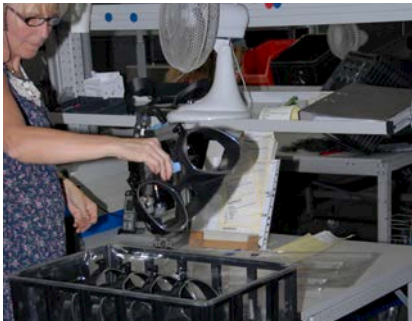
Bild 13: Einlegen und Positionieren der Frontmasken in die Varioboxxen.
