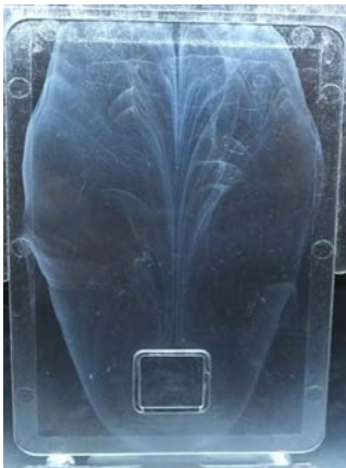
Bild 15: Füllstudie mit Fließlinien
