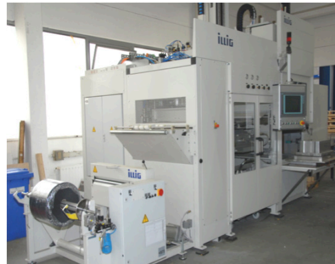
Bild 7: Vakuumformautomat mit vollautomatischer Abarbeitung vom Coil und automatischer Vorwärmung der Folien.
