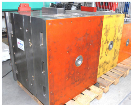
Bild 5: Spritzgießwerkzeuge für die Herstellung der Baureihen des Varioboxx-Frame
