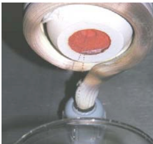
Bild 3a): Vorversuch mit freier Verdüsung an Luft
