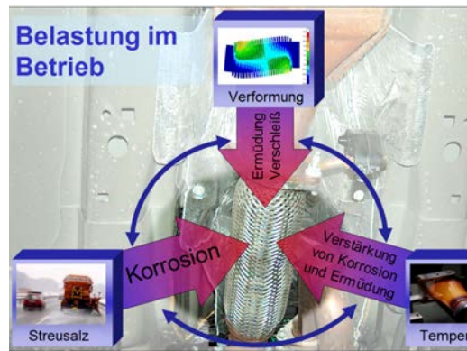
Bild 2: Belastungen im Betrieb
