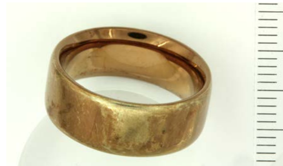
Bild 6: Ring aus Au-BMG1 b) nach 52 Tagen im Trageversuch auf Haut
