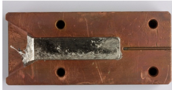
Bild 4b): massive teilbare Kupferform mit einer Platte von amorphem Au-BMG1
