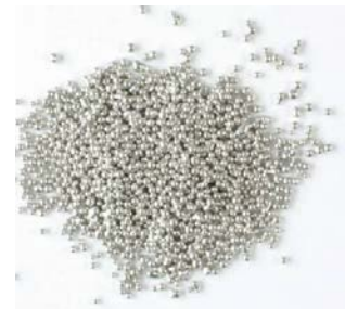
Bild 3b): amorphes Au-BMG1 Granulat mit Durchmesser 0,7–2 mm
