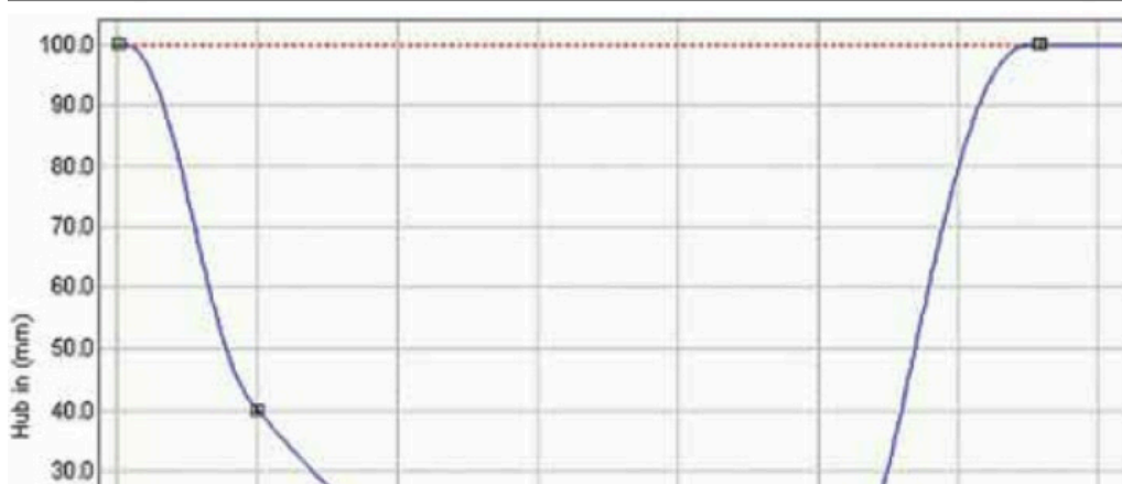
Bild 2: Beispielhafte Bewegungskurven einer Servopresse mit Spindeltrieb [Bilder: H&T]
