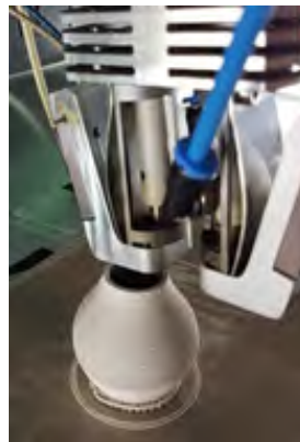
Abbildung 4: Filamentdrucker für spröde Feedstocks (drucken von ZrO_2 )
