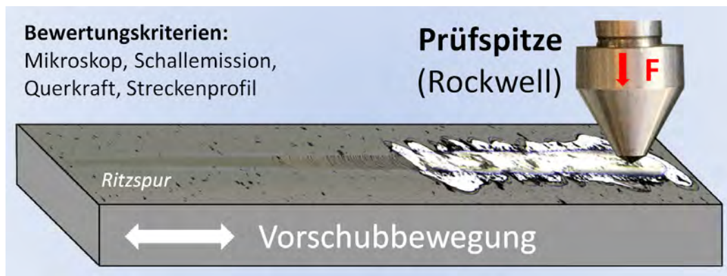
Bild 6: Funktionsprinzip Ritztest (engl.: Scratchtest), hier: Progressivbelastung, Last nach rechts ansteigend.
