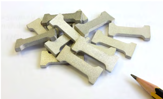
Abbildung 3: Sinterprobe aus 316L.
