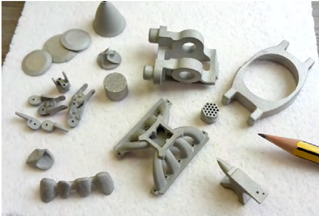
Abbildung 5: Additiv gefertigte Sinterteile aus 316L
