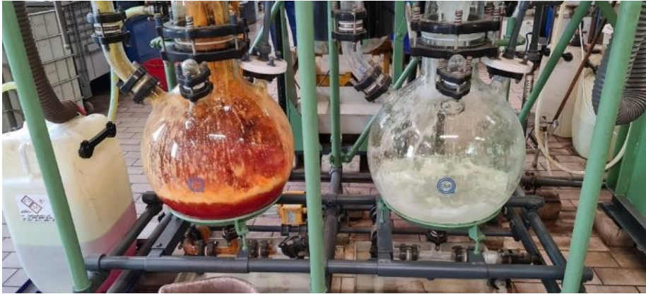
Abb. 7: Aqua-Regia-Prozess zum Goldrecycling. Foto: HSPF, Schmidt
