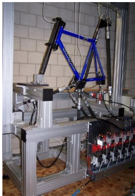
Abb. 3: Prüfstandtechnik für Fahrräder und E-Bikes, Multiforce-Prüfstand zur Dauerprüfung von Fahrrad-Rahmen
