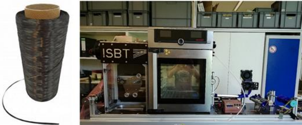
Abb. 12: Carbonfaser-Towpreg-Material (links); Faserimprägnieranlage (rechts)
