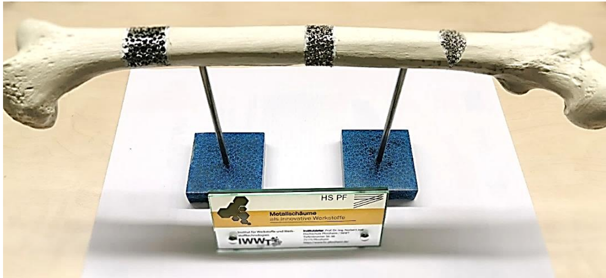
Abb. 7: Metallische Schauminsets, die unterschiedliche Frakturbehandlungen darstellen
