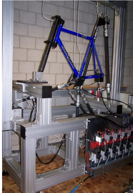
Abb. 5: Prüfstandstechnik für Fahrräder und eBikes, Multiforce-Prüfstand zur Dauerprüfung von Fahrrad-Rahmen
