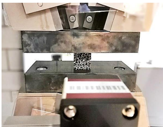
Abb. 3: Mechanische Charakterisierung von offenzelligen Schäumen: Druckversuch (links) und Ashby-Diagramm der Festigkeit von Metallschäumen verschiedener Legierungen in Abhängigkeit von der relativen Dichte (rechts).
