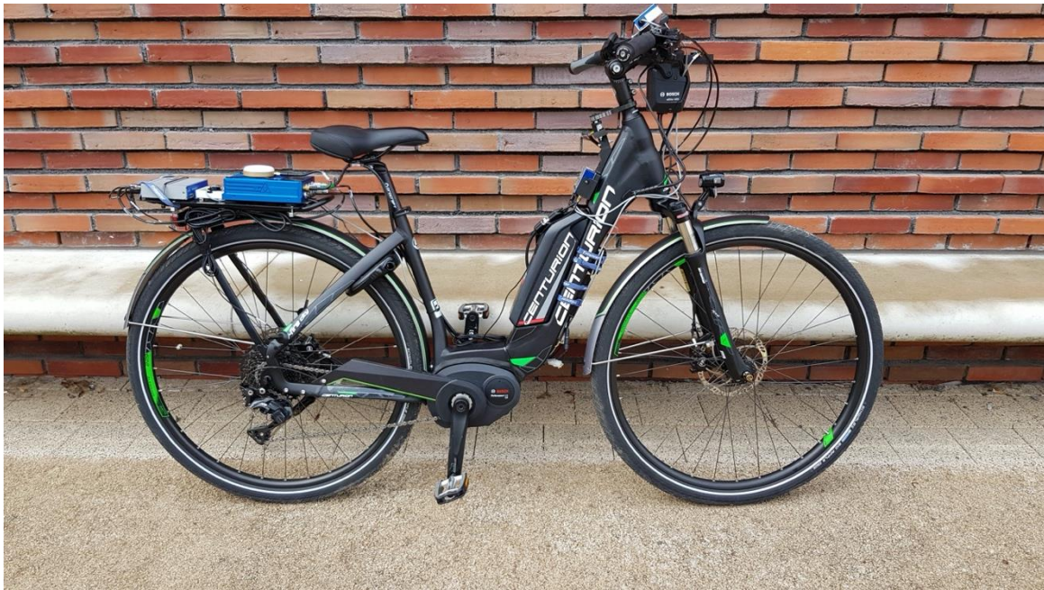
Abb. 8: E-Bike Versuchsträger Centurion E-Fire City R2500 ABS mit Messtechnik
