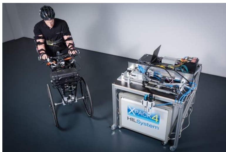
Abb. 4: Fahrerassistenzsysteme für eBikes, selbstfahrender Versuchsträger und Hardware-in-the-Loop-Prüfstand für eBike ABS aus abgeschlossenem Projekt „BikeSafe“
