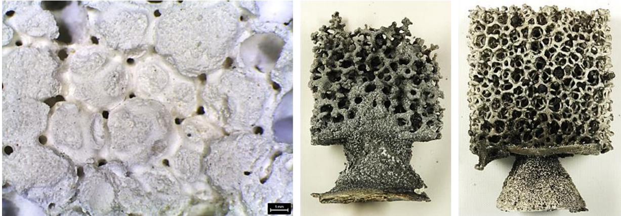
Abb. 2: In (a) ist eine mikroskopische Aufnahme einer keramischen Hülle dargestellt, das Kunststoffmodell wird ausgebrannt und hinterlässt die mit Mg zu füllenden Kavitäten. Durch Anpassung der Parameter wird in (c) die Formfüllung und Oberfläche signifikant gegenüber (b) verbessert.
