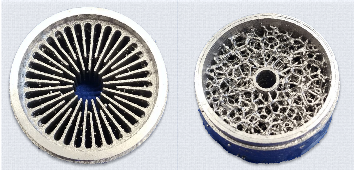
Bild 2: Struktur der Wärmeübertrager: Rippenrohr (links), Schaumrohr mit zentraler Bohrung (rechts)
