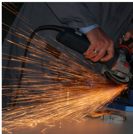
Bild: Vorführung der Schleiffunkenprobe bei der ITH-Veranstaltung „Metallrecycling - Wertschöpfung durch innovative Ansätze bei Erkennung und Sortierung höherwertiger Legierungen“ zum AMIKA-Projekt.
