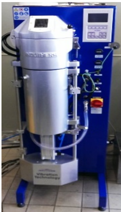
Vakuum-Druck-Gießanlage VC 500 der Fa. Indutherm zur Herstellung offenporiger Metallschäume
