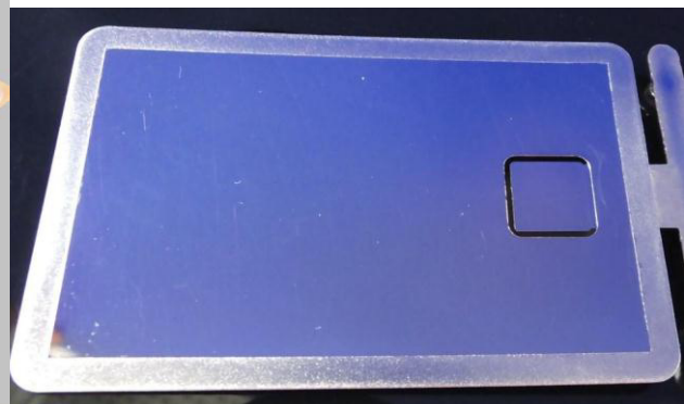
Bauteil, hergestellt mit Heißluftherwärmung der Kavität in der Einspritzphase
