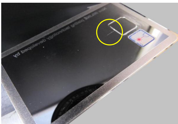
Konventionell gefertigtes Bauteil mit erkennbarer Bindenaht
