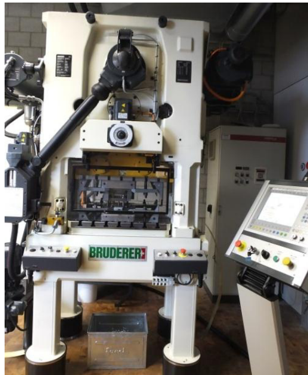
Hochleistungs-Stanzautomat BSTA 250-75B2 der Fa. Bruderer
