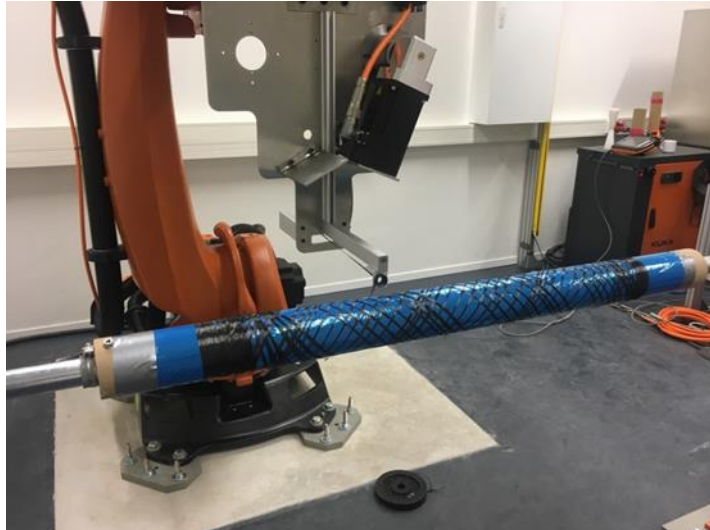
Abb. 4: Leichtbaustrukturen in Faserverbundtechnologie mit Wickelroboter
