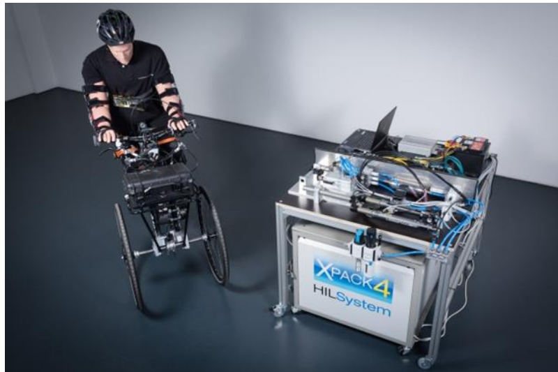
Abb. 2: Fahrerassistenzsysteme für E-Bikes, selbstfahrender Versuchsträger und Hardware-in-the-Loop-Prüfstand für E-Bike-ABS aus abgeschlossenem Projekt „BikeSafe“
