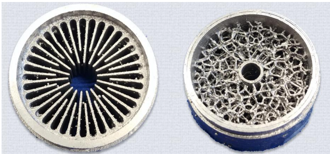
Abb. 1: Struktur der Wärmeübertrager: Rippenrohr (l.), Schaumrohr mit zentraler Bohrung (r.)
