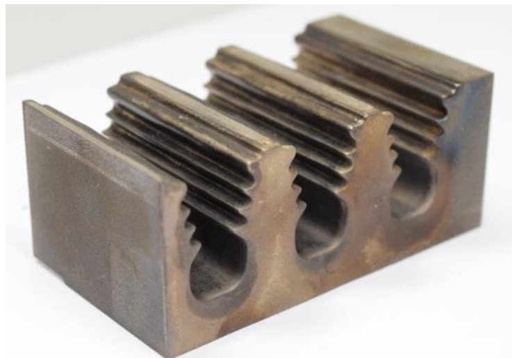
Abb. 18: Mittels Draht-ECM erzeugte „Tannenbaumprofile“, wie sie im Turbinenbau verwendet werden
