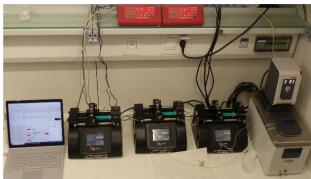
Abb. 20: Syntheseanlage für Magnetische Nanopartikel (in Zusammenarbeit mit Prof. Dr. Esther Rösch, DHBW Karlsruhe). Links: Laptop mit Programm zur Synthesesteuerung. Mitte: Pumpen für Trägerfluid und Reaktionslösungen. Rechts: Temperierbad. Oben: Zusatzpumpen für geplante Erweiterung.
