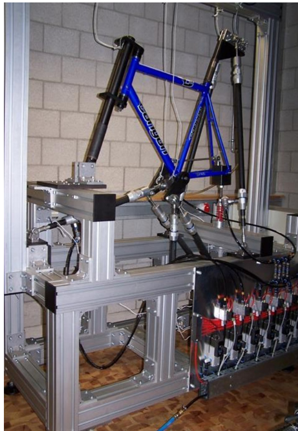
Abb. 3: Prüfstandstechnik für Fahrräder und E-Bikes, Multiforce-Prüfstand zur Dauerprüfung von Fahrrad-Rahmen
