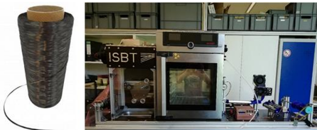
Abb. 18: Carbonfaser-Towpreg-Material (links); Faserimprägnieranlage (rechts)
