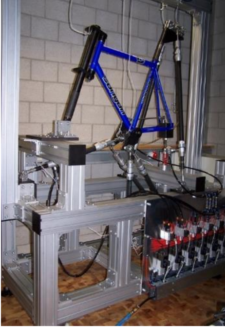
Abb. 4: Prüfstandstechnik für Fahrräder und E-Bikes, Multiforce-Prüfstand zur Dauerprüfung von Fahrrad-Rahmen
