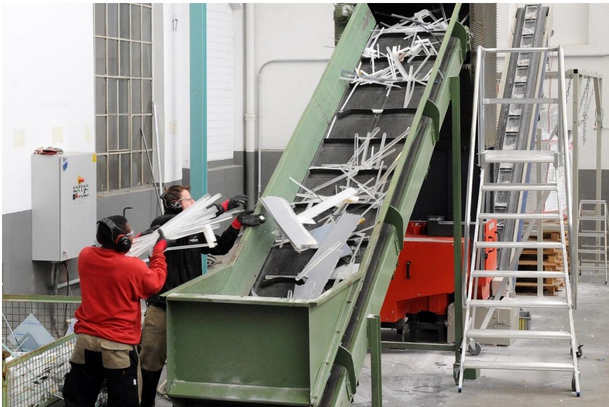
Abb. 10: Vermahlung von PMMA-Abfällen zur Verwertung beim Recyclingunternehmen Pekutherm. Foto: Pekutherm
