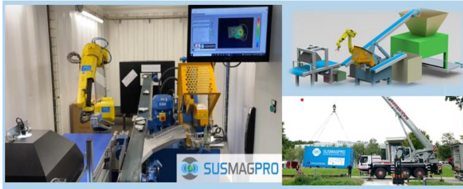
Abb. 12: Mobile Einheit zur automatisierten Extraktion von Magneten aus Computerfestplatten
