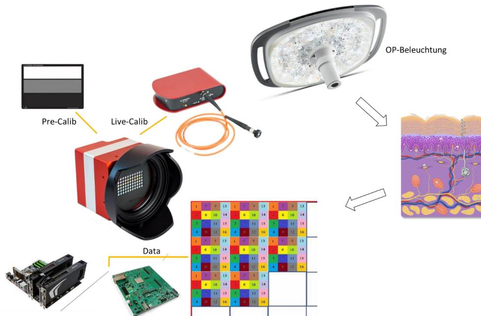
Abb. 3: Aufbau zur hyperspektralen klinischen Bildgebung unter Einsatz von echtzeitfähiger Hardware
