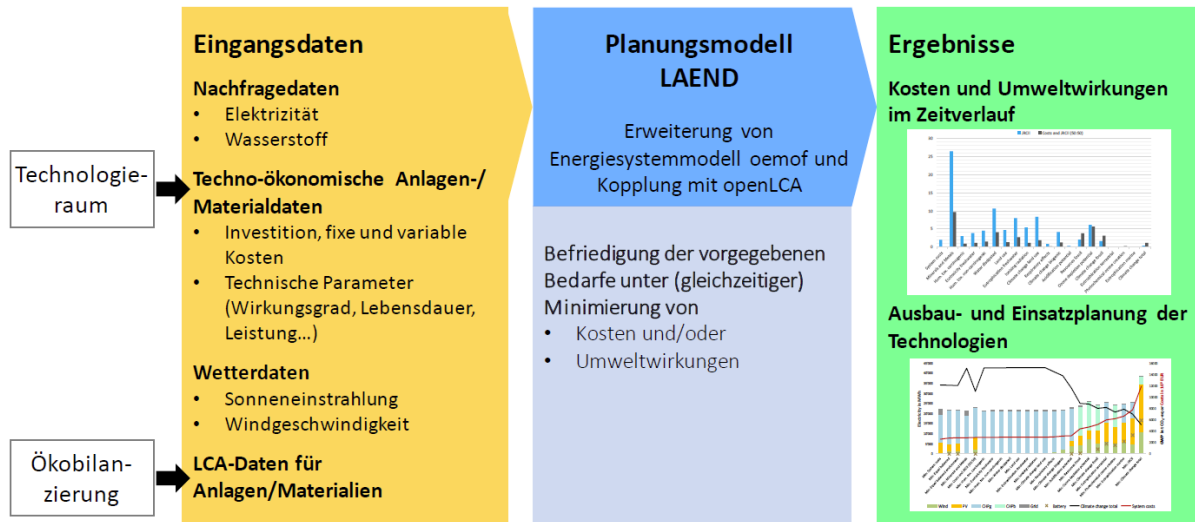
Abb. 5: Systemanalyse und Weiterentwicklung des Energiesystemmodells LAEND im Rahmen des Projektes H2-Chemie 2050
