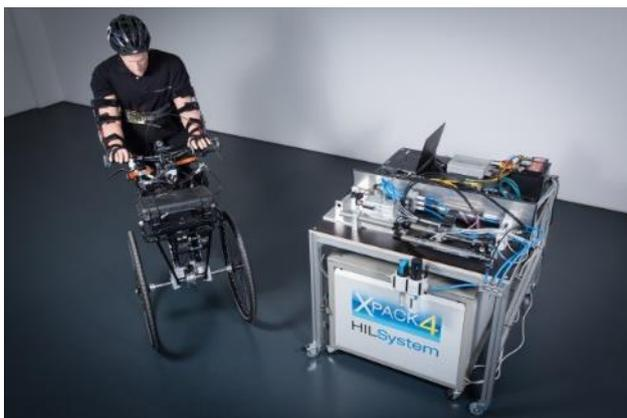
Abb. 5: Fahrerassistenzsysteme für E-Bikes, selbstfahrender Versuchsträger und Hardware-in-the-Loop-Prüfstand für E-Bike-ABS aus abgeschlossenem Projekt „BikeSafe“
