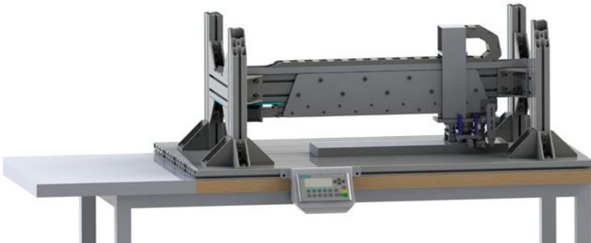
Abb. 10: Geplanter Prüfstand für die tribologische Untersuchung geschabter Oberflächen
