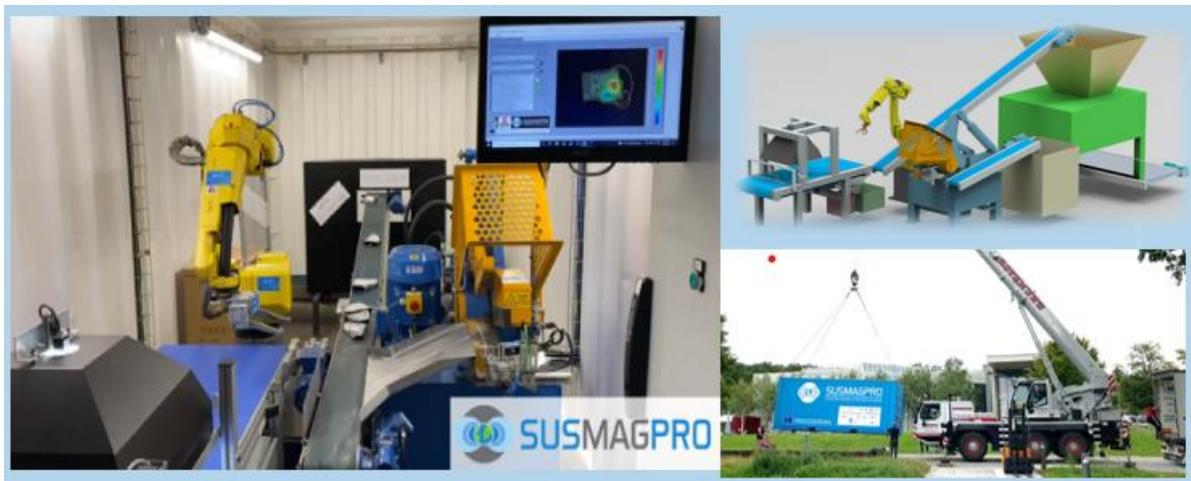
Abb. 9: Mobile Einheit zur automatisierten Extraktion von Magneten aus Computerfestplatten
