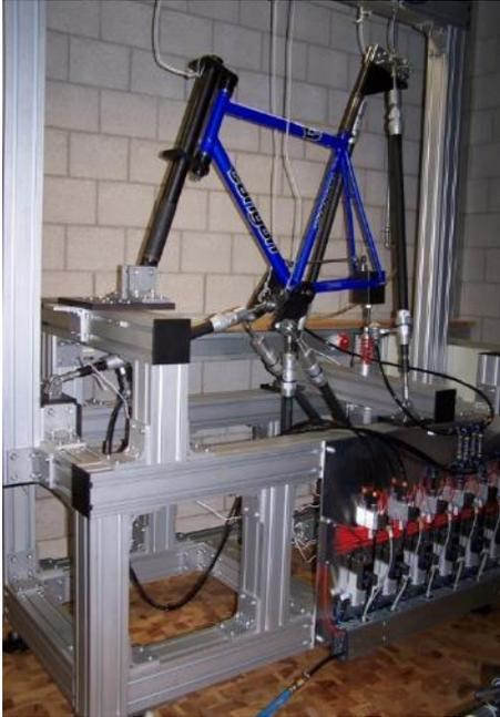
Abb. 7: Prüfstandstechnik für Fahrräder und E-Bikes, Multiforce-Prüfstand zur Dauerprüfung von Fahrrad-Rahmen
