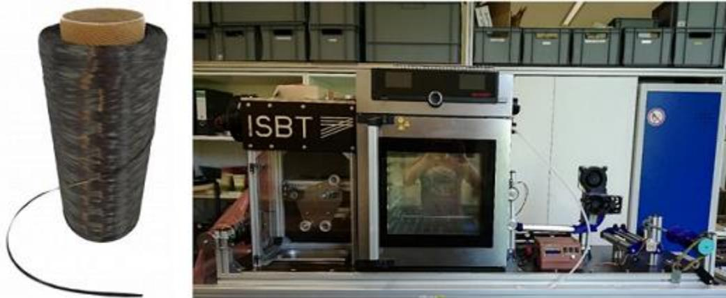
Abb. 18: Carbonfaser-Towpreg-Material (links); Faserimprägnieranlage (rechts)
